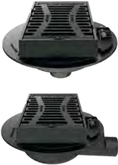
ACO broafløb Multitop HSD-2 Dimension 300 x 500 i støbejern Klasse D 400 i henhold til DIN EN 124/DIN 1229 Billedet viser artikelnr. 4979.28.00
