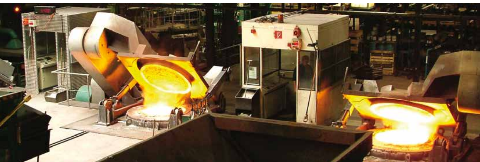
ACO støberi i Kaiserslautern benytter nye induktion smelteovne
