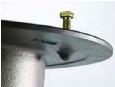
Bolt i flangen i blindhul, intet gennemgående gevindhul i flangen, hvilket giver en sikker, permanent tætning af tætnings- og beskyttelsesbanen.
