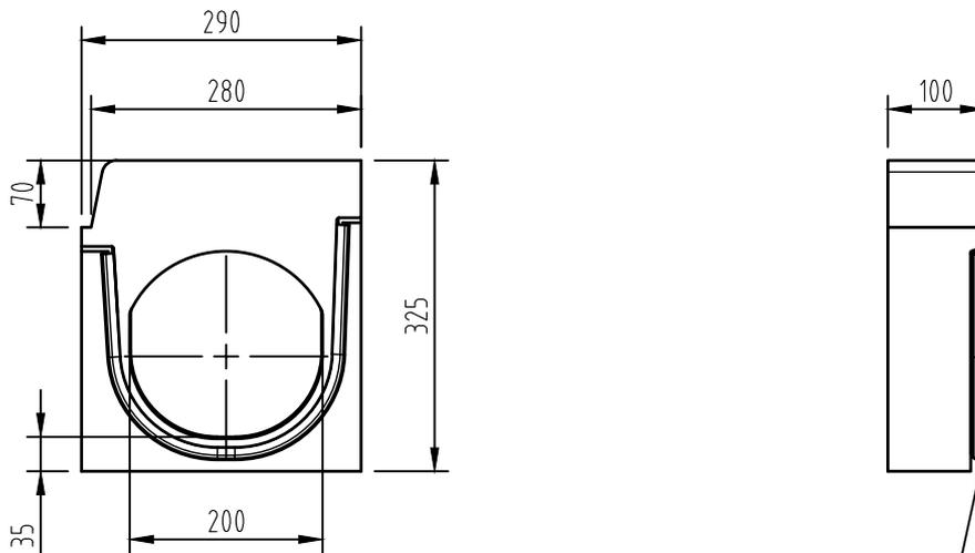
mit integrierter EPDM-Profilichtung auf der Auslaufseite zur flüssigkeitsdichtenx Verlegung von oben
