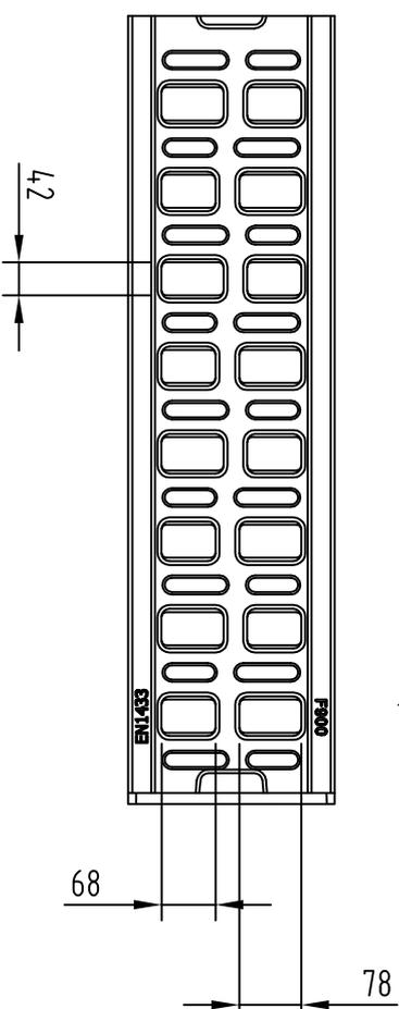
Durchfluß-Querschnitt: 308 / 695 cm<sup>2</sup>
