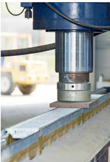
Prøvning af tæthed efter simulation over lang tid
